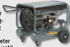
Technische Daten: 10 bar, Ansaugleistung 390 l/min, Fülleistung 300 l/min, Antriebsleistung 2,2 kW, Spannung 230 Volt, Drehzahl 1430 min<sup>-1</sup>, Behältervolumen 20 l, Geräusch 91 db(A), Gewicht 77 kg.
