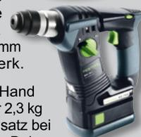
Ideal zur Bedienung mit einer Hand und für Überkopparbeiten. Mit nur 2,3 kg ideal geeignet für den Dauereinsatz bei Dübelbohrungen bspw. WDVS-Bohren und Schrauben ohne Hammerschlag. Dosensenken bis Ø 68 mm in Kalksandstein und Mauerwerk.
