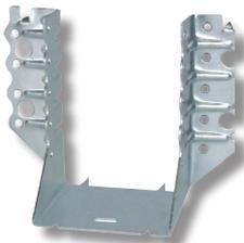
Die Ringmakierung an den Kammnägellöchern erleichtert die Arbeit bei Teilausnagelung spürbar. Die angebrachten Sicken dienen der Stabilitätssteigerung des Produkts. Bei Teilausnagelung werden 40% weniger Kammnägel benötigt. Das bedeutet eine Geld und Zeitersparnis im Vergleich zu anderen Produkten.
