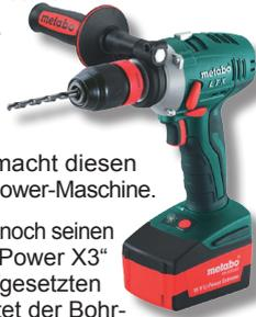
Als Weltneuheit setzt Metabo noch seinen „Hochdrehmomentvorsatz Power X3“ oben drauf. Mit diesem aufgesetzten „Drehmomenterhöher“ leistet der Bohr-schrauber rund 120 Nm. Der überraschend sanfte Anlauf bringt die Kraft sehr kontrolliert in die Schraube. Die Eindrehgeschwindigkeit wird durch das vorgeschaltete Getriebe (Übersetzung 1:3) verringert. So lassen sich z. B. Schrauben Ø12 x 650 mm mehrfach mit einer Akkuladung mühelos in BS-Holz ein- und ausdrehen.
