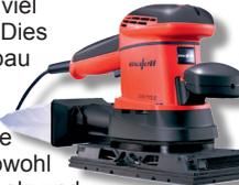
Nennaufnahme 450 W, Schleiffläche 115 x 230 mm. Hubweg 2,6 mm, Nenn - Leerlaufhubzahl 4000 - 24000 H/min, Gewicht 2,7 kg, Universal-Motor 230 V/50 Hz.
