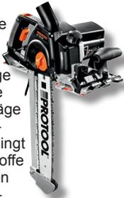
Ideal für die Baustelle: Zuschnitt dickster Dämmstoffe dank Schnitttiefe von 330 mm bei 7,0 kg Gewicht. 60°-Gehungsschnitte mit einer Schnitttiefe von 165 mm. Schnurgerade und ausrissfreie Schnitte dank PROTOOL Führungsschiene. Kettenspannung erfolgt werkzeuglos. Drehbarer Absaugstutzen zum Anschluss eines Saugers. Nicht für Holz einsetzbar.
