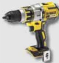
Eine neue Dreistufen-LED sorgt mit exakt ausgerichtetem Lichtkegel und einer Leuchtstärke von 77 Lumen für Helligkeit am Schraubort. Drehzahlen von 450/1300/2000 min<sup>-1</sup> stehen so zur Verfügung. Mit einem Drehmoment von 95 Nm (hart) meistern Sie Schrauben bis 8 x 500 mm ohne Vorbohren.
