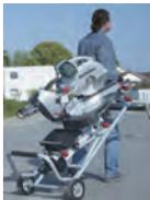
Bei der Arbeit dient der KSU 250 Mobile als praktischer und robuster Sägetisch. Er ist aus Stahl und Aluminium konstruiert, hat Hartgummireifen und trägt bis zu 250 Kilogramm, mehr als jeder andere vergleichbare Ständer. Sein Maschinenträger ist ohne Werkzeug montierbar und nimmt nahezu alle gängigen Kapp- und Paneelsägen auf, von Metabo ebenso wie von anderen Herstellern. Der Tisch ist ausziehbar und lässt sich von 150 auf bis zu 250 cm Länge erweitern.
