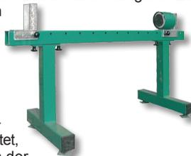
Die Zylinder werden durch eine Höhenverstellung mittig ausgerichtet, so dass ein Aufwölben der Balkenlage vermieden wird. Mit einem Handgriff wird das Spannpaket mit 14 kN (1,4 t bei 10 bar) gespannt. Der Zylinder spannt sofort nach, wenn sich die Sparren beim Ausrichten durch Klopfen aneinander legen.
